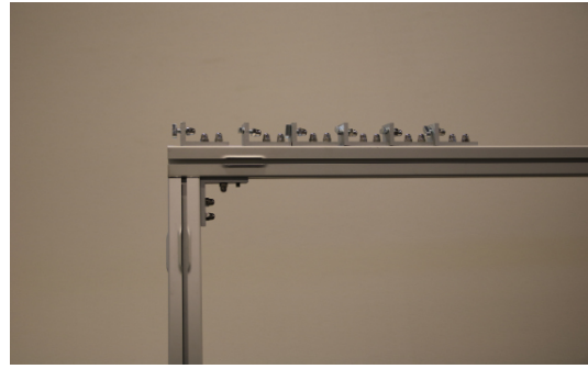
*5 - Lagg i de förberedda B-vinklarna på ovansidan av överliggaren, alla ska peka åt samma håll förutom en.
